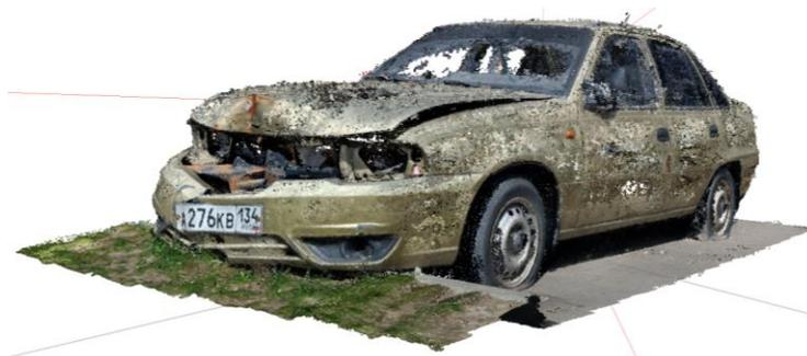
*Рис. 3. Полученное после создания плотного облака точек изображение автомобиля*
