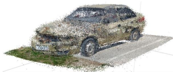
*Рис. 2. Полученное после выравнивания снимков изображение автомобиля.*
