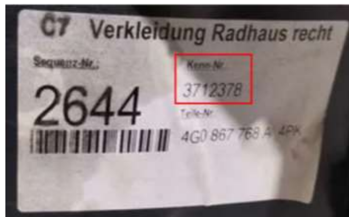
Иллюстрация №3. Внешний вид производственного номера в графе «kenn-nr».
