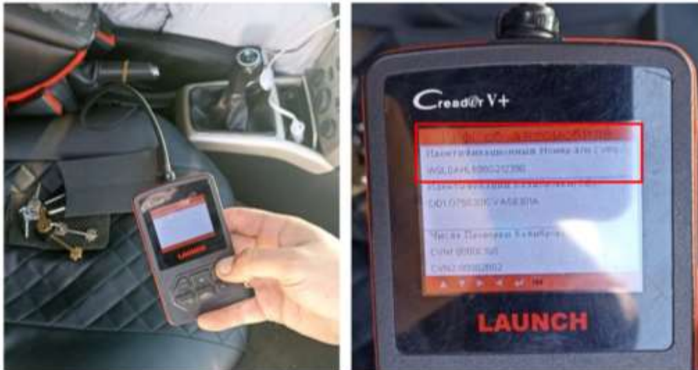
Иллюстрации №1-2. Процесс считывания VIN с помощью диагностического сканера.
