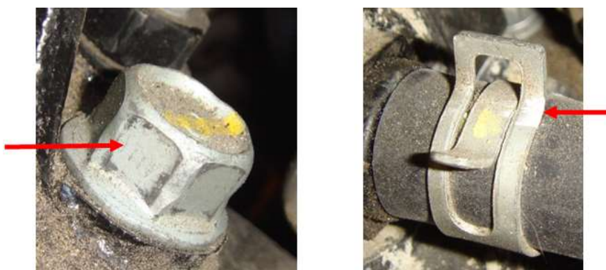
Иллюстрация № 4-5. Места крепления со следами механического воздействия.
