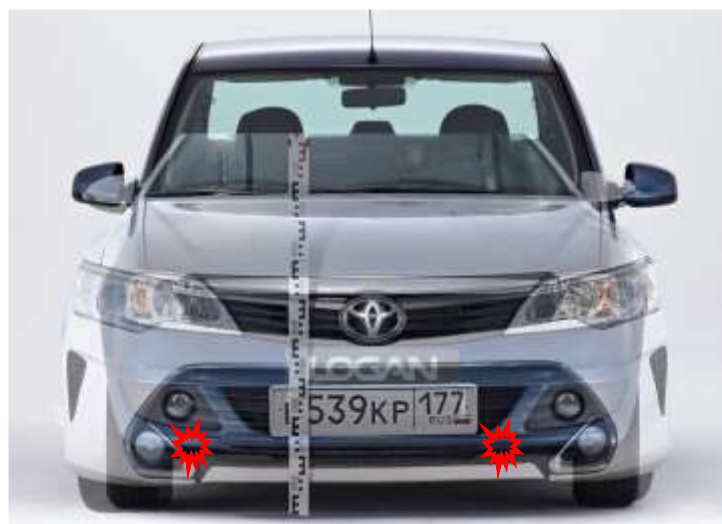
Иллюстрация № 4. Фотографическое моделирование локализаций следов от выступающих частей автомобилей.
