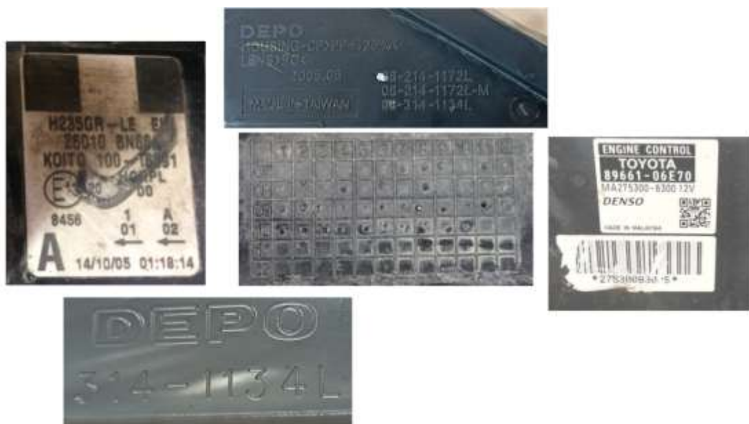
Иллюстрация № 6. Особенности структуры маркирования частей автомобиля «Тойота Камри».
