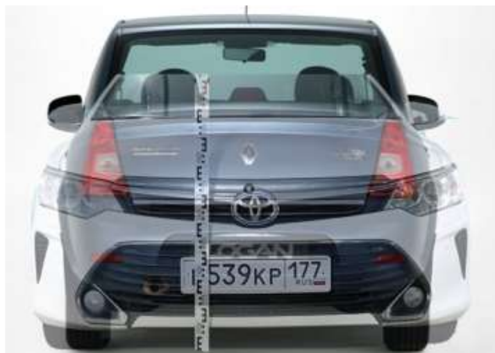
Иллюстрация № 5. Фотографическое моделирование локализаций следов от выступающих частей автомобилей.
