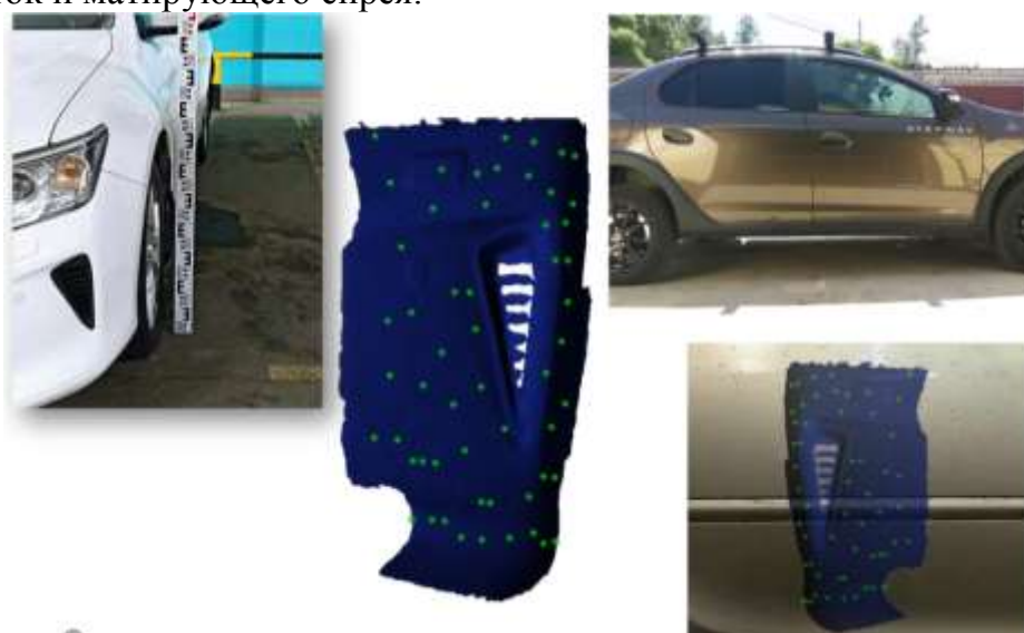
Иллюстрация № 9. 3D-сканирование как способ моделирования (сопоставления) частей исследуемых автомобилей.
