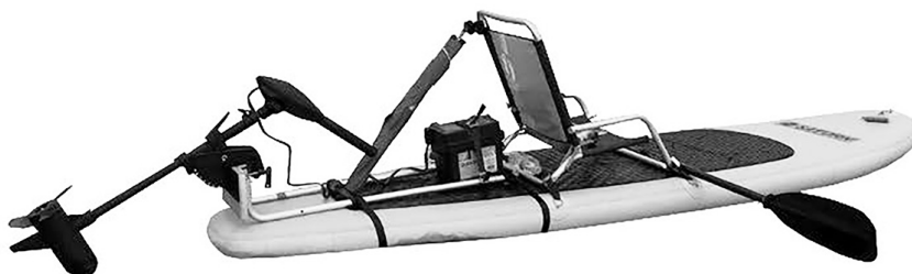
Рис. 2. Сапборд, оснащенный электрическим двигателем (приводом) 10
