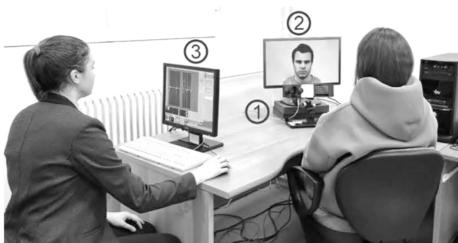
Рис. 2. Изучение глазодвигательной активности человека с помощью настольного айтрекера
