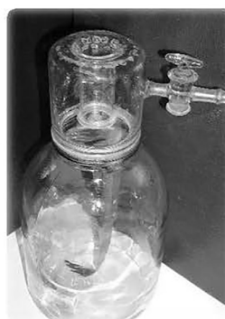
Рис. 1 и 2. Устройства для термовакuumного извлечения пахнущих следов из объектов-следоносителей в сборниках пахнущих веществ
