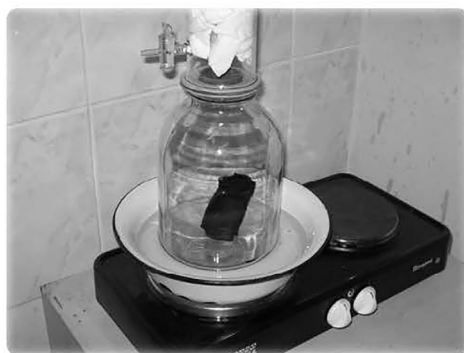
Рис. 1 и 2. Устройства для термовакuumного извлечения пахнущих следов из объектов-следоносителей в сборниках пахнущих веществ
