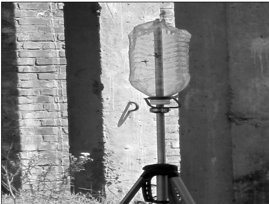
Рис. 4. Крестиками на пластиковой банке отмечены входное и выходное отверстия
