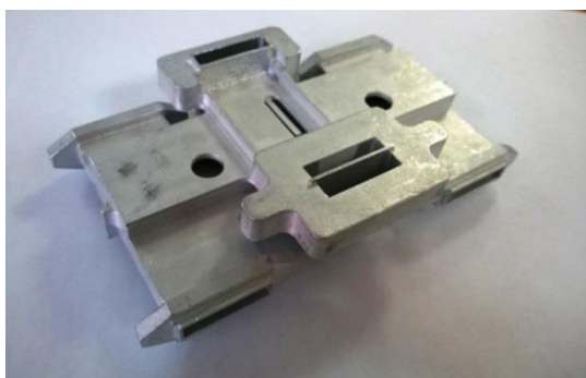
Алюминиевая деталь со сложной внутренней структурой
