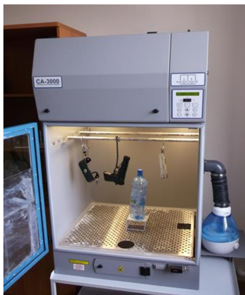
Обнаружение невидимых потожировых следов рук путем обработки (окуривания) в атмосфере паров цианакрилата или нингидрина на оружии, документах
