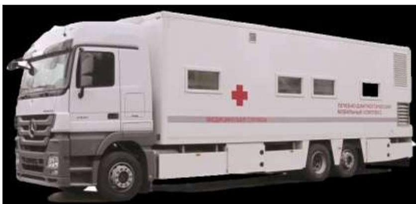
*Рис. 3а. Мобильный комплекс ПКЛ-КТ на базе шасси автомобиля Mercedes сборки КАМАЗ с изменяемой геометрией кузова для исследования и идентификации тел и их фрагментов.*
